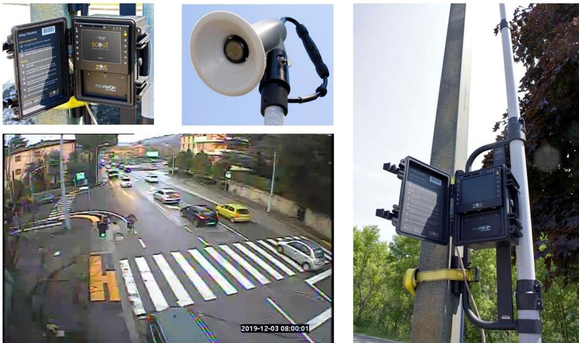
Figura 137 Sistema di acquisizione video e decodifica automatica delle immagini mod. MIOVISION
